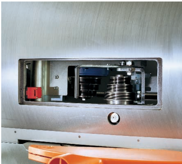
Cambio della velocità situato sul piano di lavoro. Changement de la vitesse situé sur la table d'usinage. Speed change on work table. Geschwindigkeitsänderung auf der Arbeitsplatte. Cambio de la velocidad colocado sobre el plano de trabajo.
